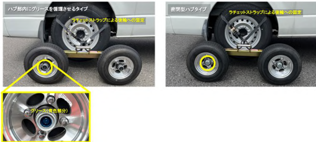
<図4-1-5 使用したドリーとドリー装着の状況>
