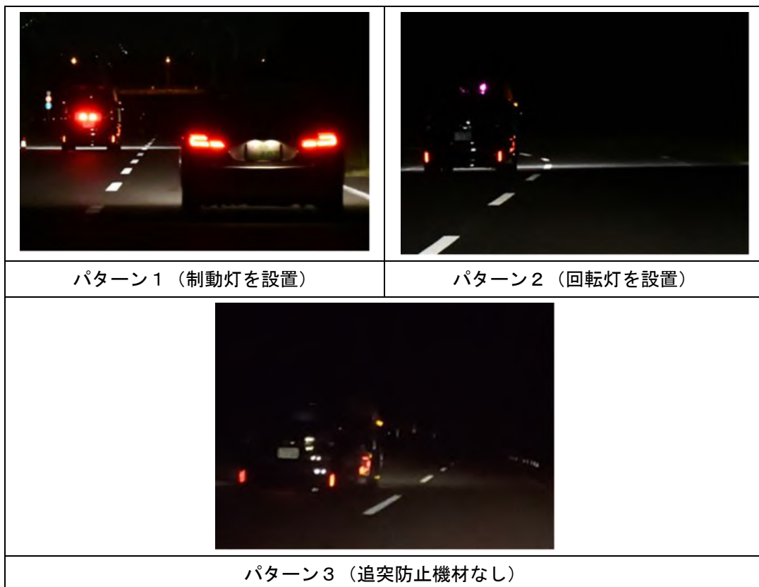
＜図3-6-1 実験2のパターンと追突防止機材の設置状況＞
