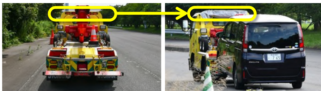
<図3-3-3 キャブの背後のフレームに設置された制動灯及び方向指示器の遮蔽状況>
