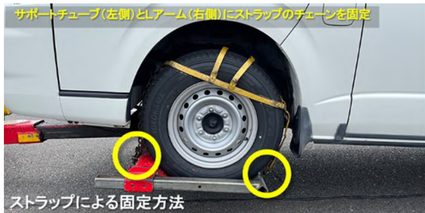
<図4-1-4 被牽引車の固定方法>
