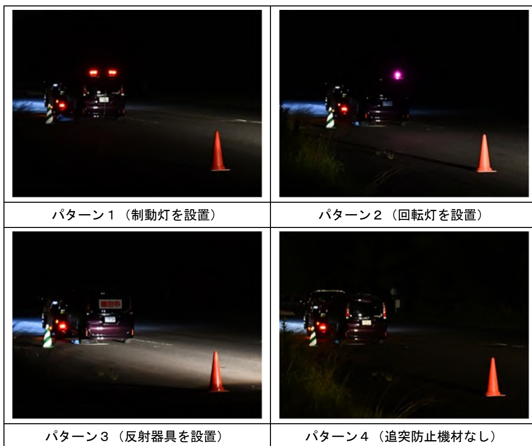
＜図3-5-1 実験1のパターンと追突防止機材の設置状況＞
