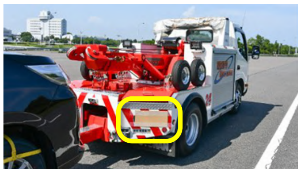
＜図 3-6-4 レッカー車のブレーキランプに目貼りをした状態＞
