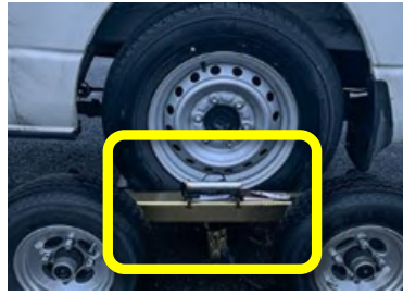
走行中にラチェットストラップが脱落した状況
